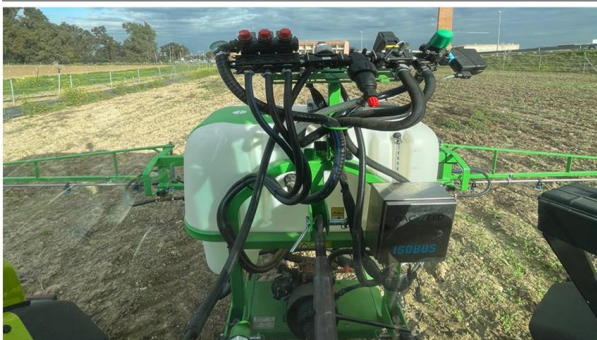
Figura 2 – Aplicador selectivo DACWEED controlado por ISOBUS
